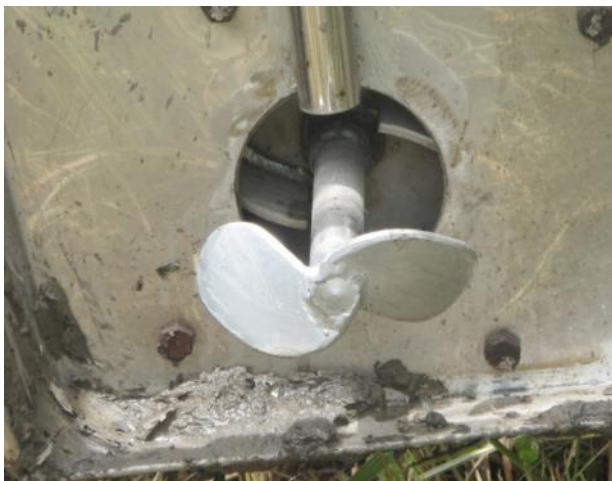
ใบพัดแบบสองตอนเพื่อปั่นตะกอนเลน
