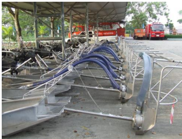
ตะกอนเลนที่ถูกดูดขึ้นมาจะผ่านทางสายยาง และถูก ควบคุมให้ไปยังตำแหน่งที่ต้องการ
